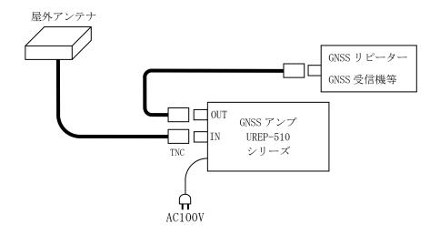
本装置のACコンセントプラグを電源と接続し、電源スイッチを入れる、本装置フロントパネルのLEDが点灯いたします。
